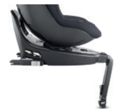
Sistema di fissaggio a 3 punti (2 agganci Isofix + gamba di supporto). 3 anchoring points (2 Isofix connectors + support leg).
